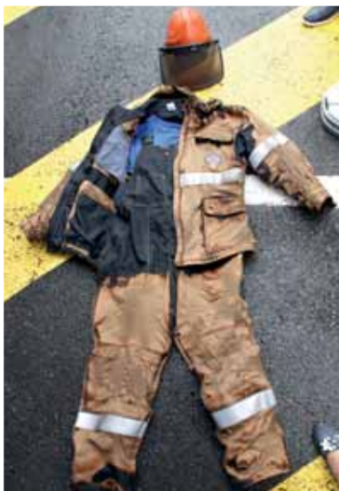
Бывший в употреблении костюм нефтяника из ткани Номекс® после испытания огнем
