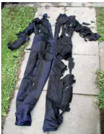
Результат испытания нового хлопчатобумажного костюма импортного производства с огнестойкой пропиткой — общая площадь ожогов 2-й и 3-й степени на «теле» манекена составила 52 %
